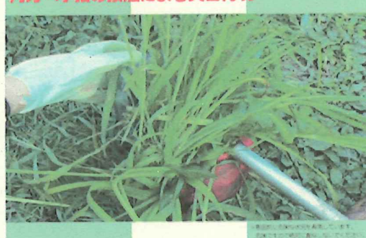
刈刃へ手指の接触による災害再現
